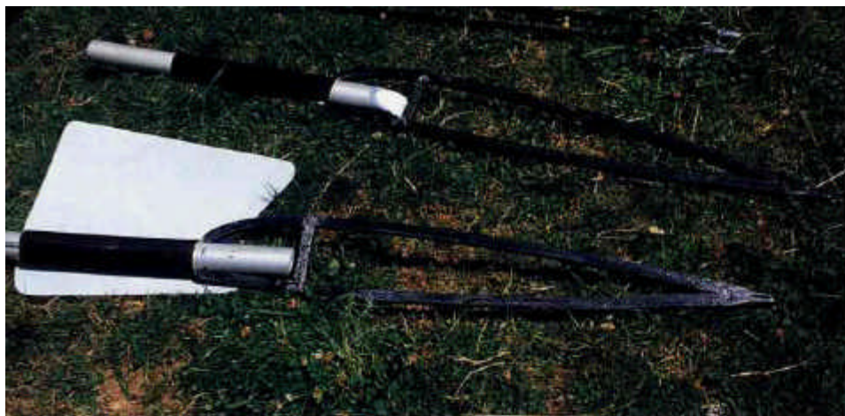
Robust: die äußersten Klapprippen mit den Flügel-Endrohren, darüber die schwarz eingefärbten GFK-Randbögen
