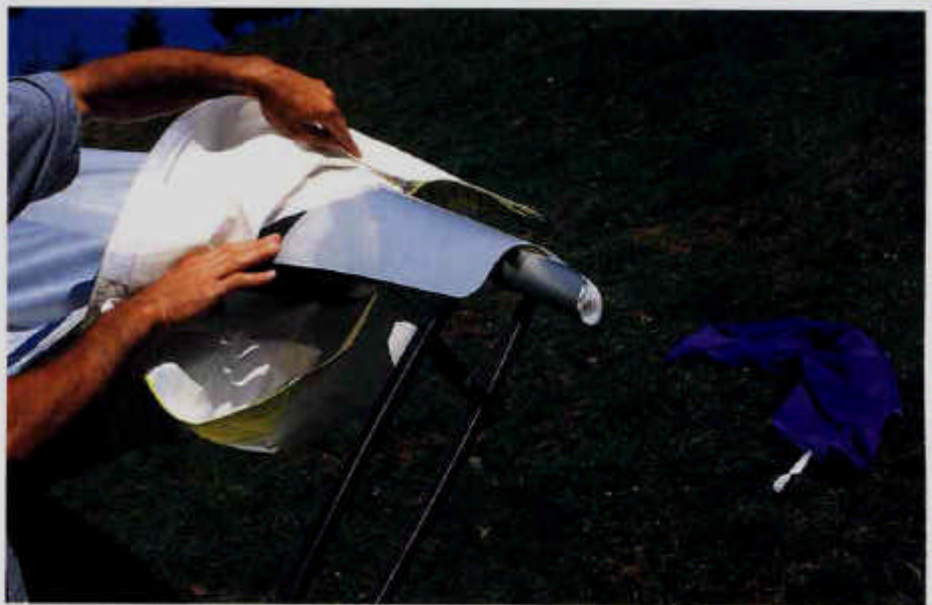
Flügelende: Der D-Holm ist außen durch ein Alurohr verlängert. Für einen sauberen Übergang sorgt Mylarfolie. Anders als die inneren Rippen, wird die äußerste beim Abbauen nach außen geklappt
