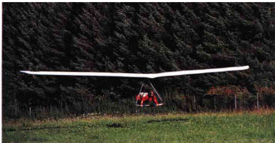
Kein Stress bei der Landung: Mit ausgefahrener Klappe ist der Gleitwinkel halbiert – angenehm nicht nur bei Landungen auf kurzen Wiesen. Das gute Handling erlaubt Richtungskorrekturen auch dicht über dem Boden
