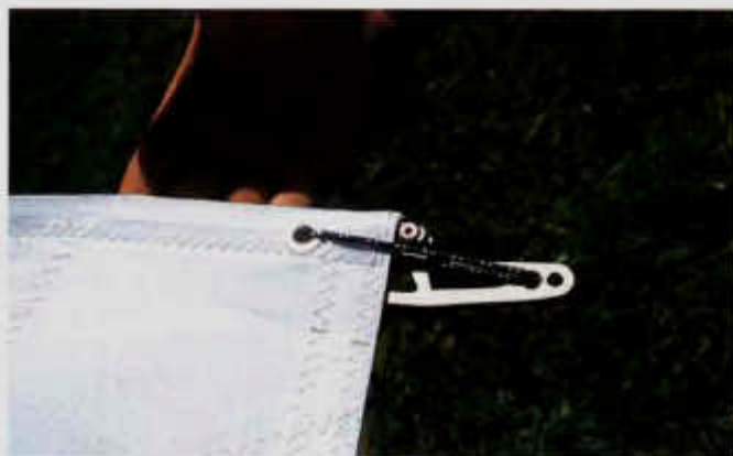
Wie beim Drachen: Ist der Randbogen gespannt, schaut nur noch der äußere Teil des Hebels aus dem Segel. Elegant wäre eine ganz abgedeckte Konstruktion
