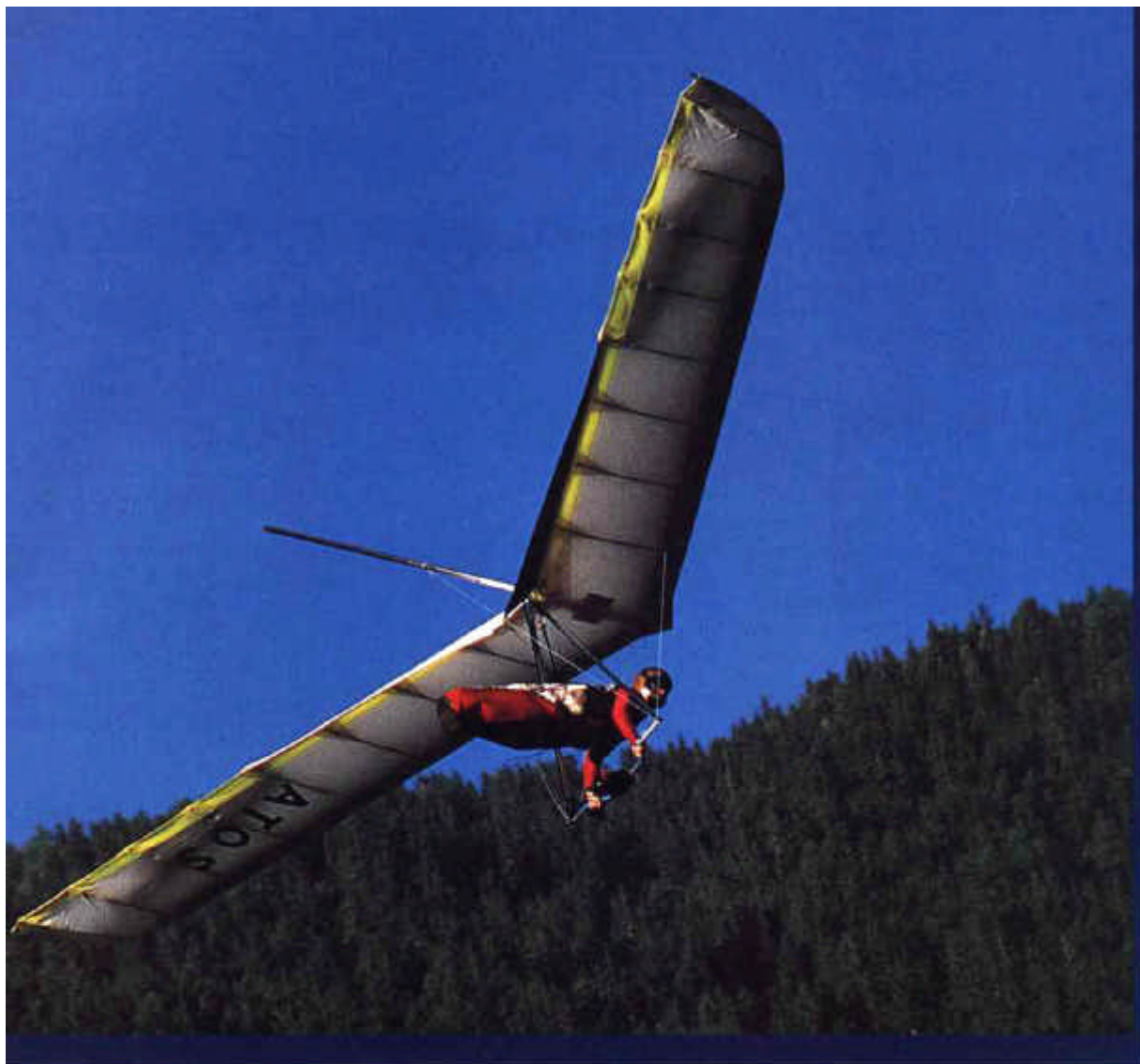
In der Mitte verkürzt: Die Flügel des großen Atos wurden an der Wurzel um je ein Rippensegment »amputiert«. Trotz geringerer Streckung wirkt der »S« aber genauso schlank wie das um zwei Quadratmeter größere Modell
