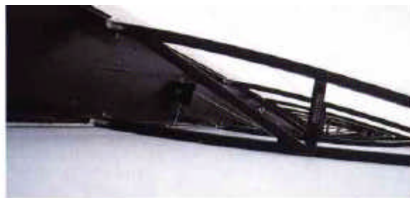
Alles aus Kohle: Die Klapprippen sind an der Hinterkante der D-förmigen Flügelhülse drehbar befestigt. In Bildmitte die Umlenkung des Steuerseils
